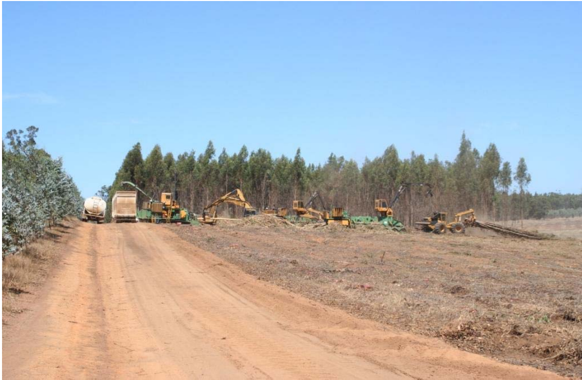
写真 III-2-2-5 スキッター（右）による収集とインフィールドチップパー（左）による破碎とトラック輸送
