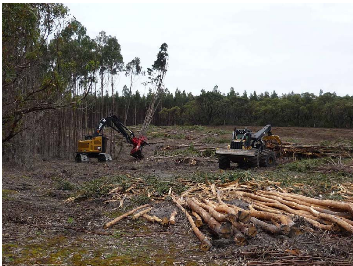
写真 III-2-2-4 フェラーバンチャー（左）による伐採
