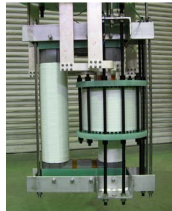
図 2.3.1-24 低損失巻線モデルの諸元と外観
