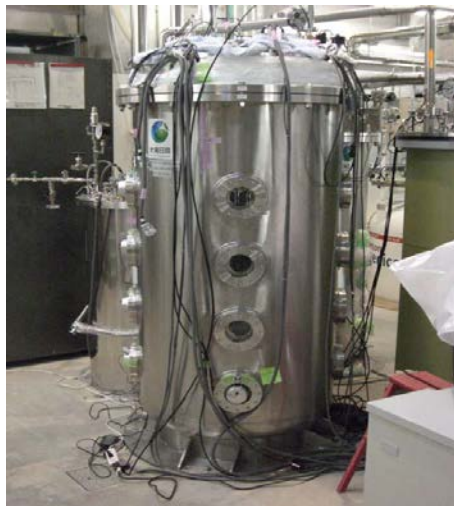
図 2.3.2-42 変圧器クライオスタット内で液体窒素と熱交換する冷却システムを模擬した装置の外観図
