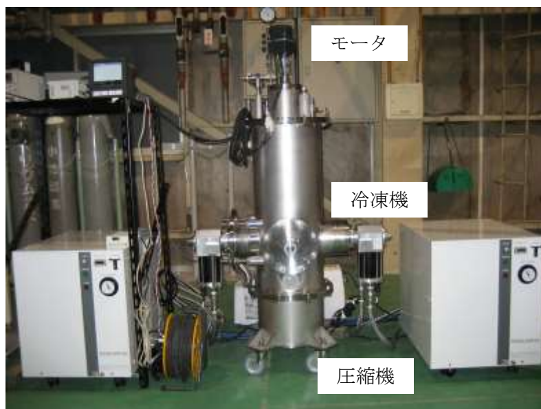
図 2.2.6-5 スラッシュ窒素生成装置の写真
