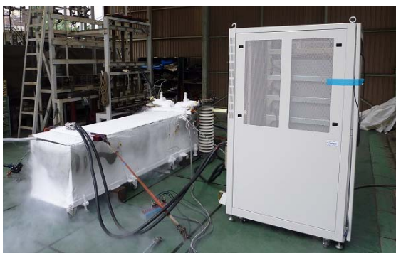
図 2.2.3-67 直流電源による I_c 測定
