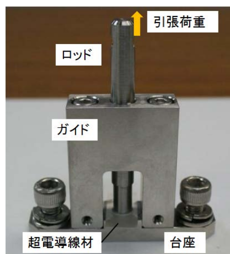
図 2.1.5-1-2 剥離耐性試験方法
