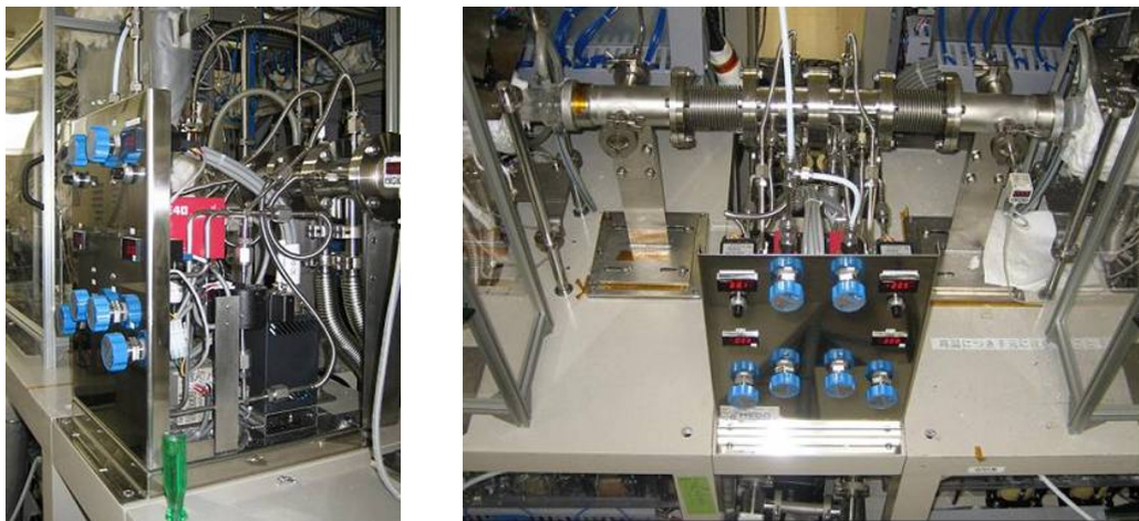
図 2.1.3-1-7 ガスバランスシステム
