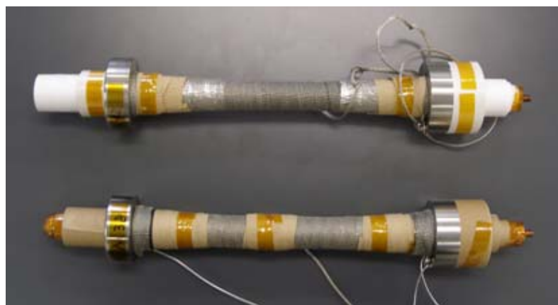
図 2.2.3-2 絶縁モデルケーブルの外観 (上が C 紙、下が B 紙)
