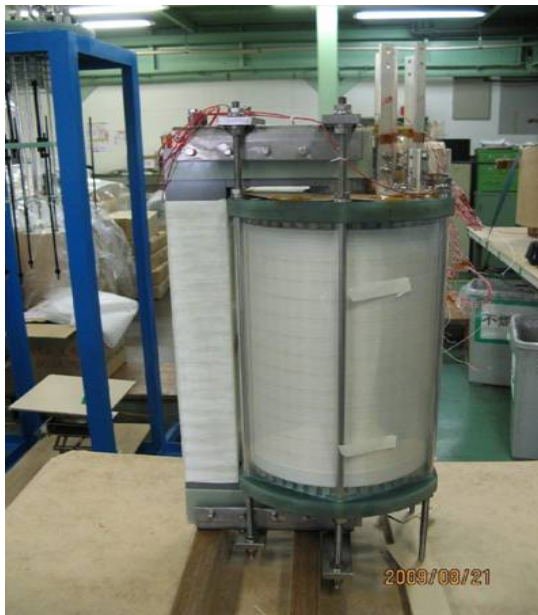
図 2.3.3-4 4巻線構造変圧器 (巻線、鉄心) の外観
