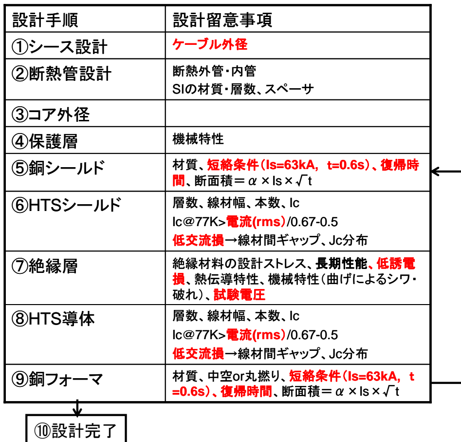
図 2.2.3-16 275 kV 超電導ケーブルの設計フロー
