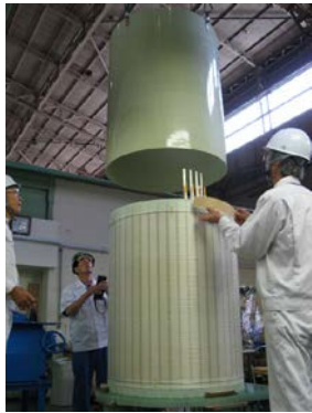
巻線組立作業
