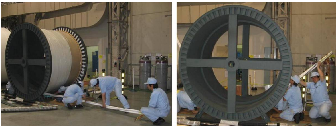
図 2.2.1-78 三心ケーブルコアの曲げ試験
