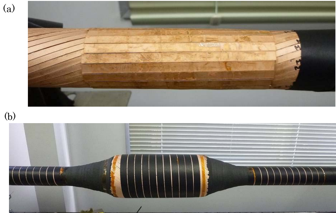
図 2.2.3-70 耐過電流試験に供試した中間接続部。(a)導体接続部、(b)補強絶縁上に設定したシールド接続部
