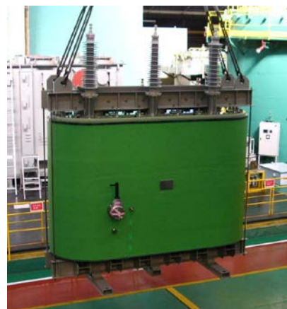
2 MVA 級変圧器モデル完成
