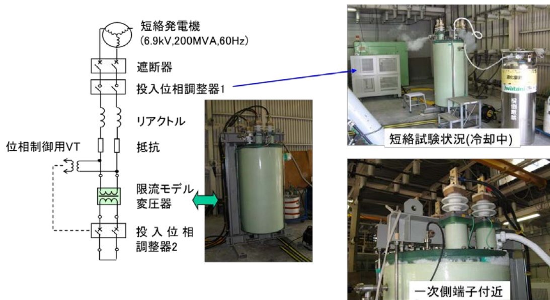
図 2.3.3-46 限流特性試験回路とその写真
