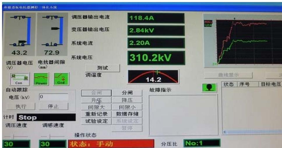
図 2.2.4-16 長期課通電試験後の 310 kV・10 分の課電
