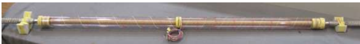
図 2.2.5-34 作製した 2 層導体
