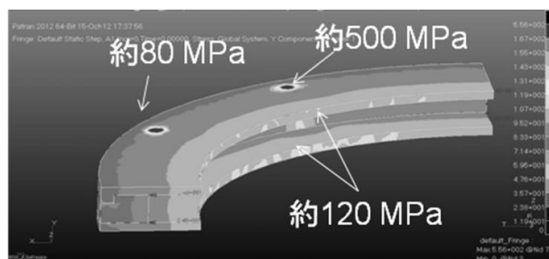
図 2.1.5-2-14 周方向応力分布の解析結果
