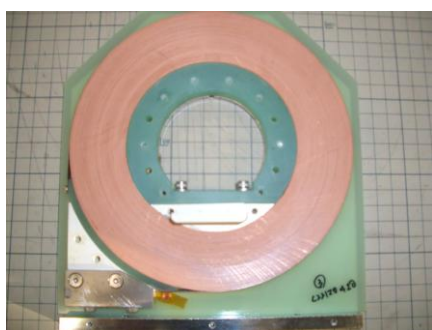
図 2.1.5-2-5 絶縁被覆とパラフィンモールドを施した SP コイルの外観
