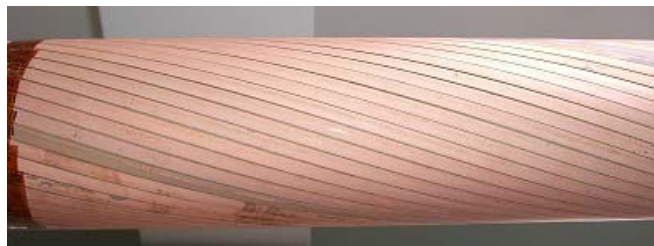
図 2.2.3-59 超電導導体 (上)、超電導シールド (下)
