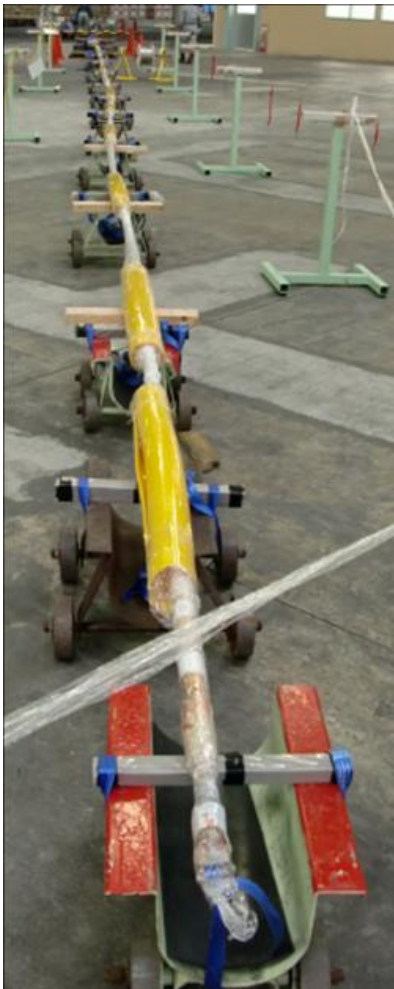
図 2.2.1-38 ケーブル単心コアの外観
