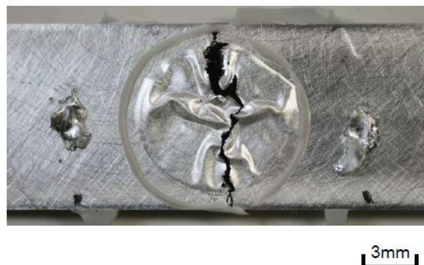
図 2.1.5-1-4 剥離耐性試験後の試験片
