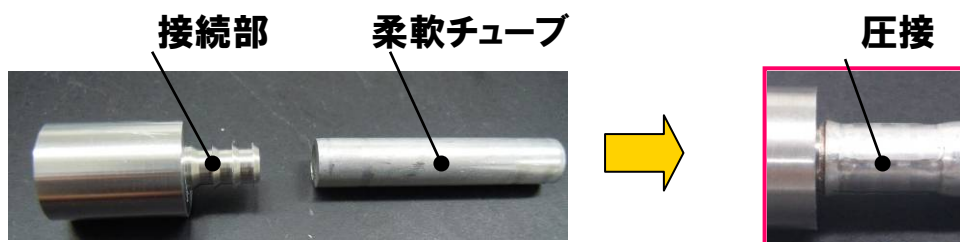
図 3.2.5-4 柔軟金属チューブと接続構造
