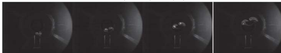
100ms 200ms 300ms 400ms 燃焼面伝播挙動(R1234yf、φ1.35)
