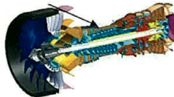
高圧圧縮機高圧力比化 (6段 ⇒ 9段)
