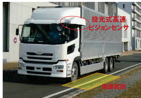
トラック実験車に搭載した投光式高速ビジョンセンサ
