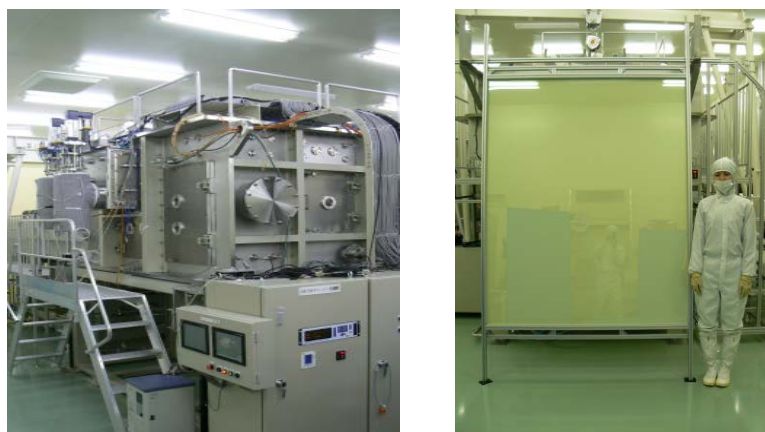
図Ⅲ-2.3B.1-2. 試作したG6基板対応面蒸着装置とG6蒸着基板
