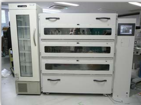
図 2-1.自動培養装置全体像
