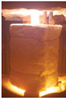
気中溶解の様子(RFプラズマ加熱)
