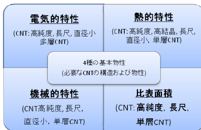
図 III-45 4つの基本特性に対応するCNT構造
