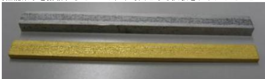
図 III-70 高熱伝導性材料に金メッキを適用
