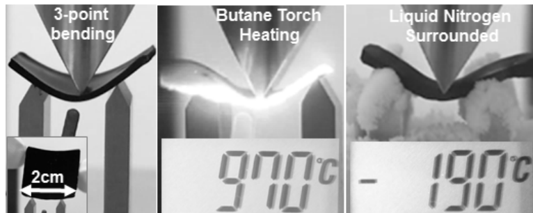
図 III-41 -190~970°Cの範囲で粘弾性とコンプライアンスを示したCNT材料
