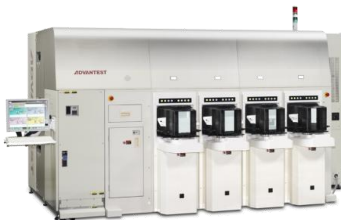
図Ⅳ-4 開発された 300mm ウェハ 4 枚同時一括テスト装置
