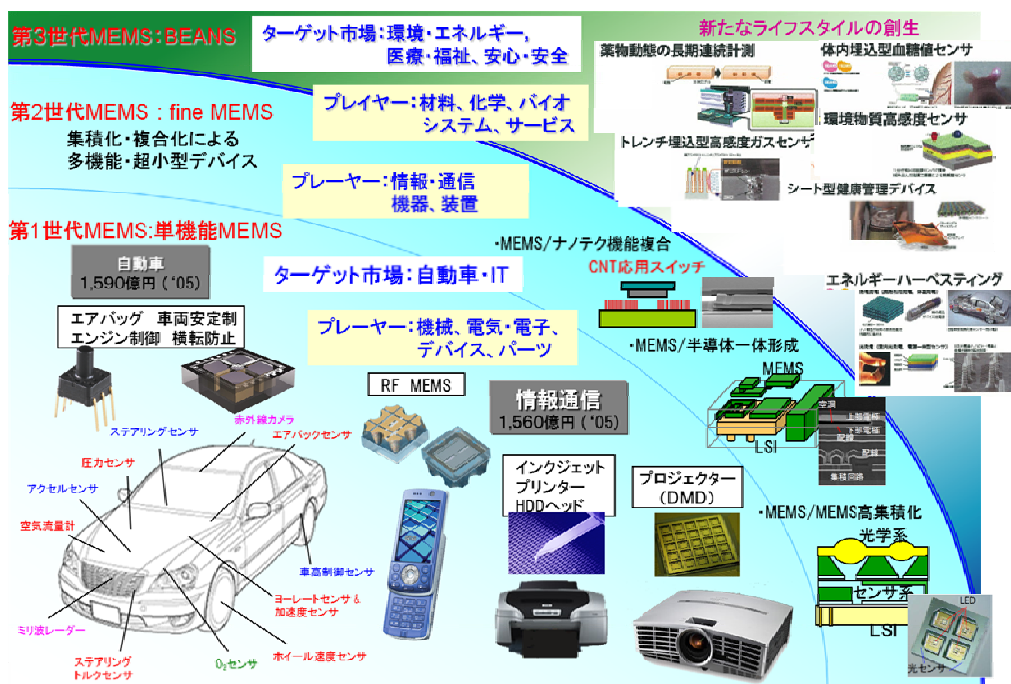
図 1 第 3 世代 MEMS: BEANS の位置付け (Bio Electromechanical Autonomous Nano Systems: 異分野融合型次世代デバイス及びその製造技術) 出典(財)マイクロマシンセンター
