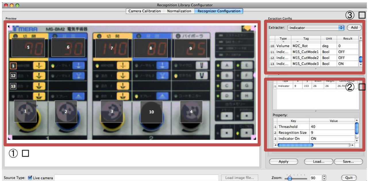
図 6: 医療機器ログシステムの認識例 この画面は、パネル設定ファイルを編集するソフトウェアの画面である。①が正規化されたパネル画像、②が数字表示器などの要素ごとのパラメータを設定する部分、③が認識結果を表示している
