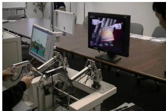
図1 トレーニング用シミュレータと実機コンソールの接続実験
