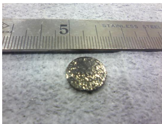
図③-1 得られた窒化鉄ナノ粒子のディスク状成型体
