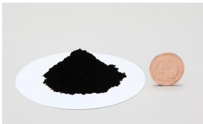
図②-1 大量合成した窒化鉄ナノ粒子の外観写真。
