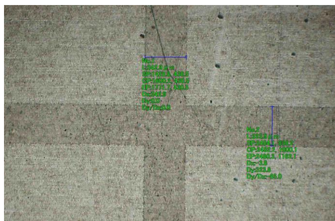
レーザー加工を施したPET上のグラフェン膜の光学顕微鏡写真
