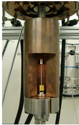
図 2.1.(1).5 圧力容器(カットモデル,左)と新しく製作した CuBe2 シンカー(右)
