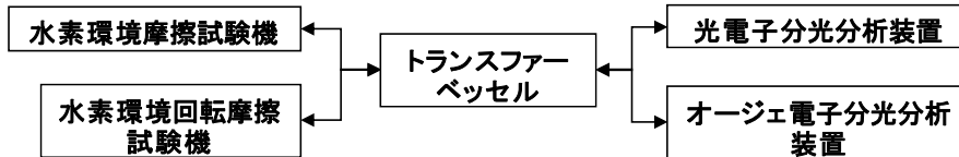
図 2.4.(1).1 トランスファーベッセルを用いた実験システム
