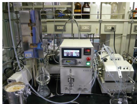
上写真 内径20Φ～50Φmmフロー リアクター全体図 左写真 左:50Φ×300mm 右:10Φ×300mm
