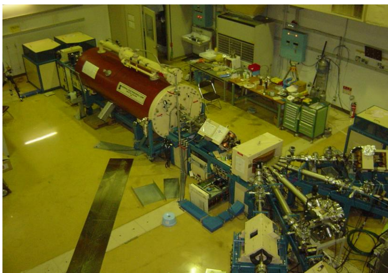
図Ⅲ2.3.-(51) 本研究で RBS および ERDA 解析に用いた 5SDH-2 静電加速器 (神戸大学大学院海事科学研究科)。
