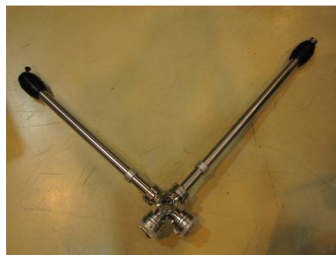
図 III.2.3.-(105) 試料導入・回収機構。
