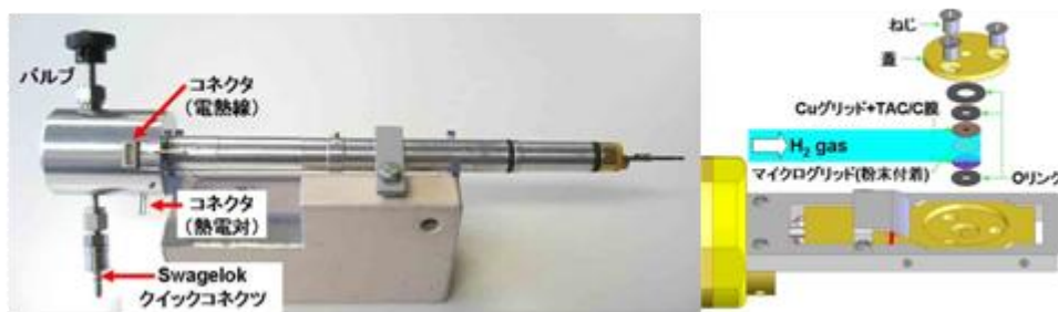
図III.2.2-(34) 加熱型環境セルの外観と先端部の拡大模式図
