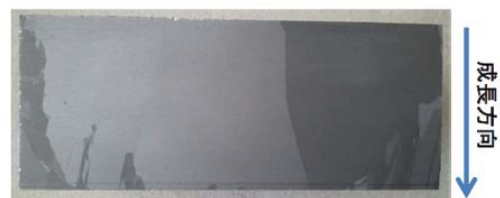
図Ⅲ-2-(イ)-A-1(33) インゴットの外観写真。左が標準ルツボを用いて成長したもの。右は二重ルツボを用いて成長したもの。
