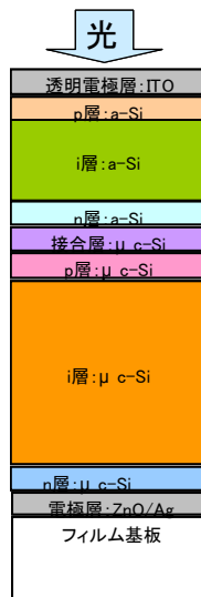
図Ⅲ-2-(ロ)-D-1(3) 2 接合太陽電池の構造
