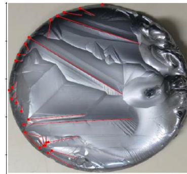
図Ⅲ-2-(イ)-A-1(30) 面内温度分布による融液表面に発現するデンドライト成長の制御
