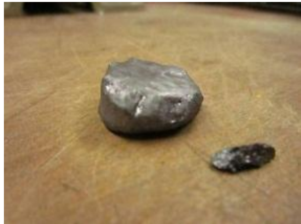
図Ⅲ-2-(イ)-D-1[6] 精製シリコンの外観
