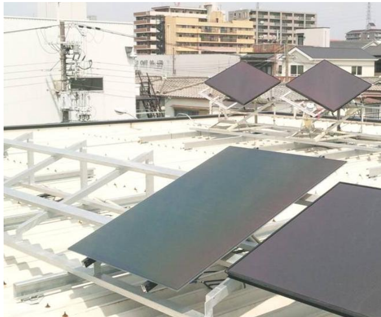
図Ⅲ-2-(ロ)-C-1 [7]. 1420×1100mm サイズの 3 接合モジュール外観写真 (屋外暴露中)
