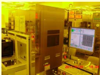
OPCデータ取得用測長SEMと多点測定ソフトウェア(Design Gage)
