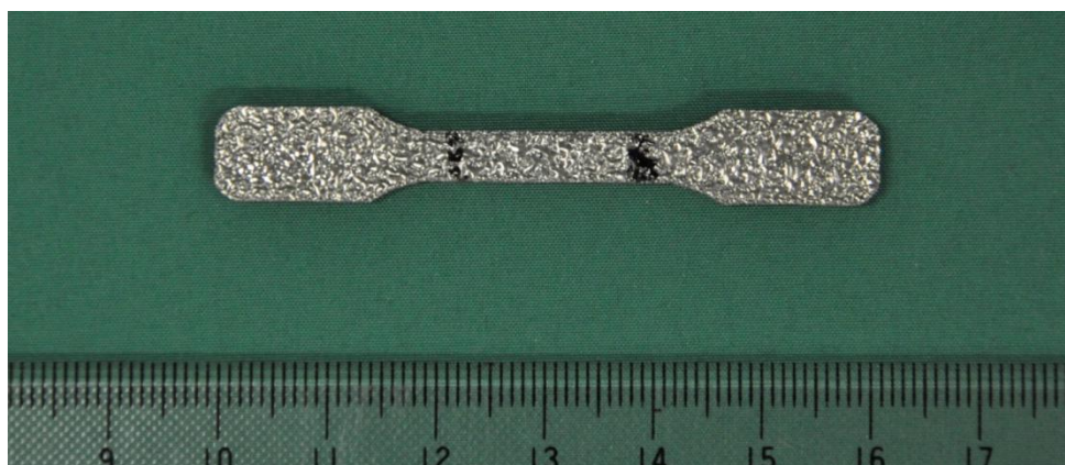
図Ⅲ-2.18.19 実際に作成した引張試験片
