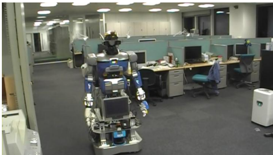
図 3.2.1.-20 リファレンスハードウェアを用いた自律移動実験
