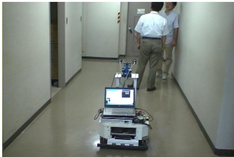
図 3.2.1.-19 リファレンスハードウェアを用いた自律移動実験
