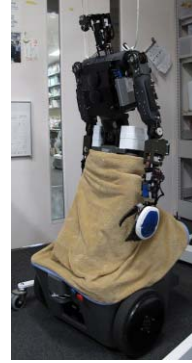
作業移動ロボット外観
