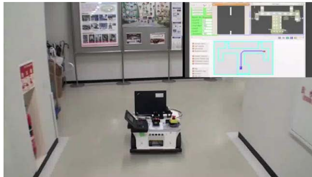
天井画像に基づく位置推定を行うリファレンスハードウェア
