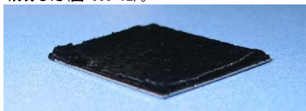
図 III-12 ウェットプロセス触媒/金属基板で合成した SGCNT 配向集合体
