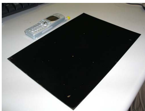
図 III-14 A4 サイズ金属基板上に合成された SGCNT 配向集合体
