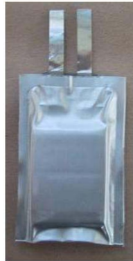
図 III-6 SGCNT 積層ラミネートキャパシタ
