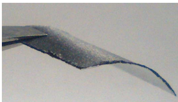
図 III-40 バインダーフリーSGCNT キャパシタ電極
