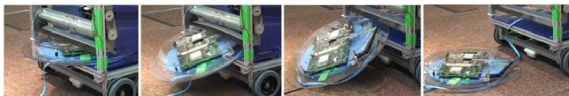
図60 無線基地局敷設のシーケンス
