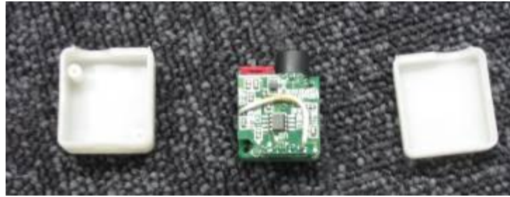
図38 省電力型加速度センサ内蔵超音波タグ
