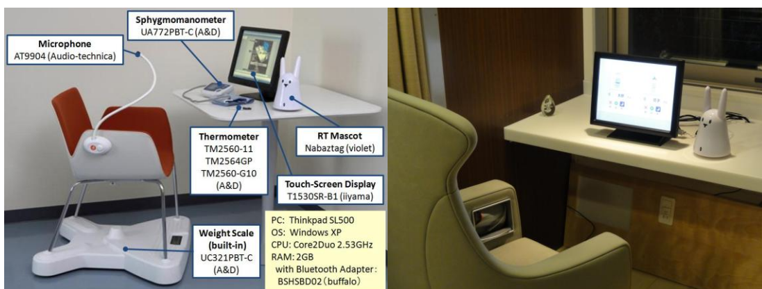
図2 在宅健康管理・支援システム（左：モニタ試験用／右：事業化プロトタイプ）
