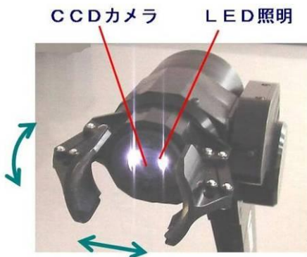
図 21 電動ハンドの構成
