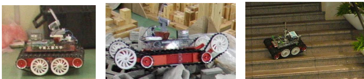
(a) 高速走行の姿勢 (b) 瓦礫上走行の姿勢 (c) 階段途上での信地旋回
