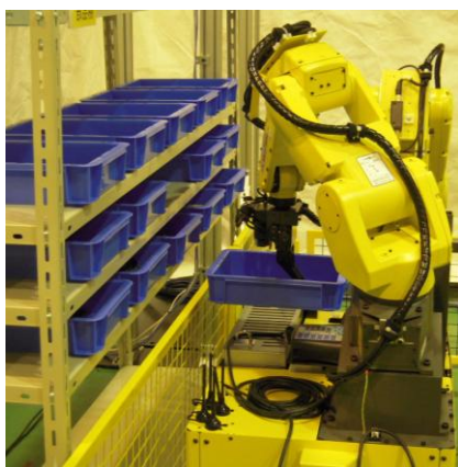
図 5 移動配膳協調ロボットによる部品キット化・配膳
