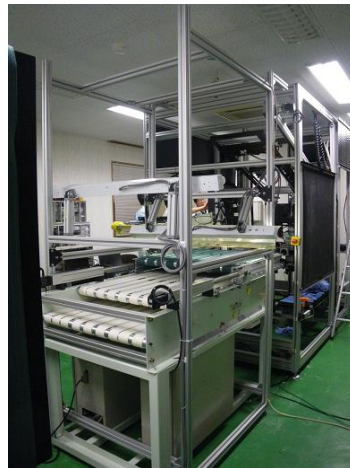
図 2.1-39 3段コンベアによる表裏反転・排除
