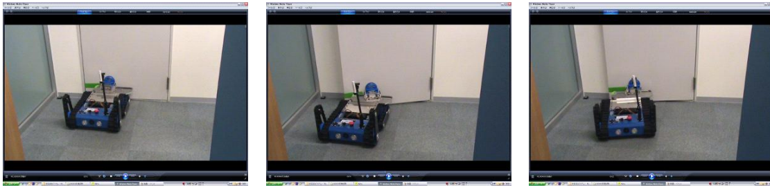
<Step1>吸着&マニでドアラッチ解除 < Step 2>後進-1, マニ収納 < Step 3>台車旋回-1
