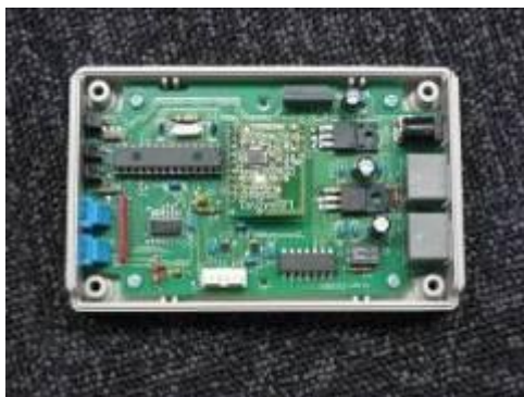
図 42 大規模センサネットワーク構築可能なタグコントローラとハンドオーバ機能を利用した広範囲タグ追跡
