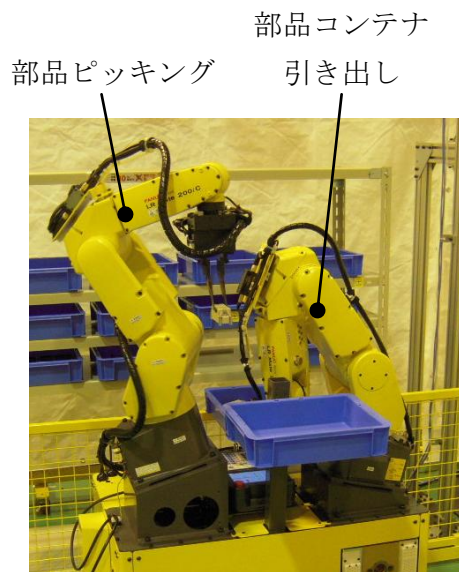
図 20 双腕ロボットアームによる部品ピッキング
