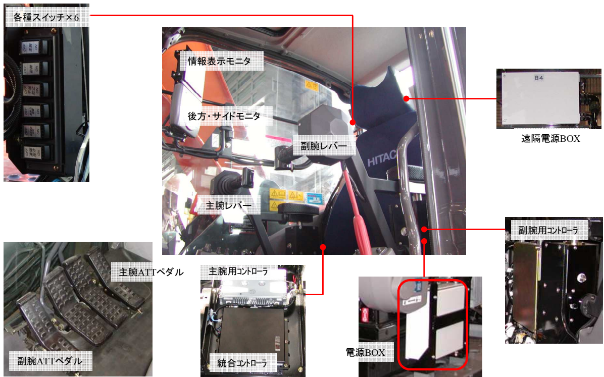
図 25 運転室内搭載機器
