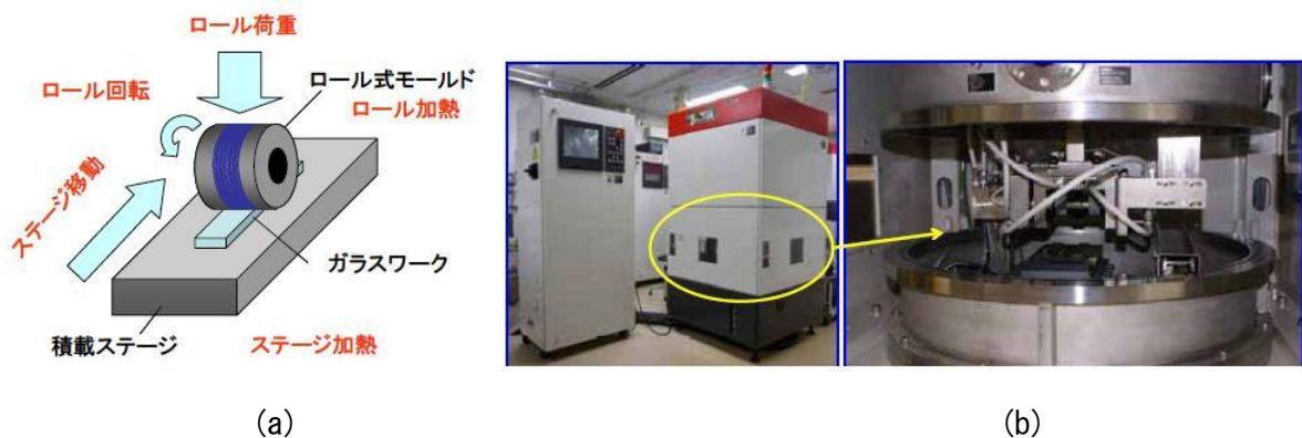
図Ⅲ-30 (a) ロール成形機の構成、(b) 装置の外観
