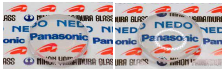
図Ⅲ-21 反射防止構造を形成した凹面 SiC モールドで成型したリン酸塩系ガラスレンズ (a) と同じ曲率で反射防止構造のないレンズ (b) の光学写真
