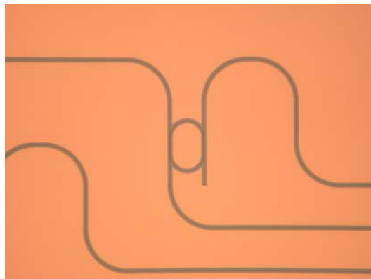
Ⅲ-2- I -②-(2)-図 34 試作したリング共振器型光分波器 ( r = 40 \mu\text{m} )
