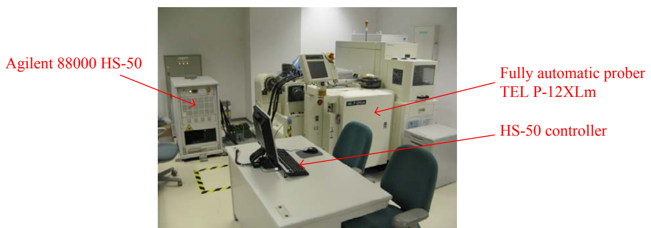
III-2-1- (1) 図 6-4 NBTI 測定システムの概観。全自動プローバはウエハ温度を、233 K から 473 K の範囲で保つことができる。
