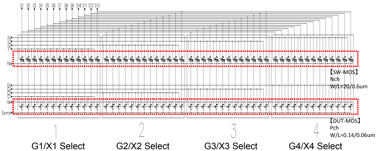
III-2-I-③-(1)図 1-1-2-8 シンプルアレイ TEG の回路模式図
