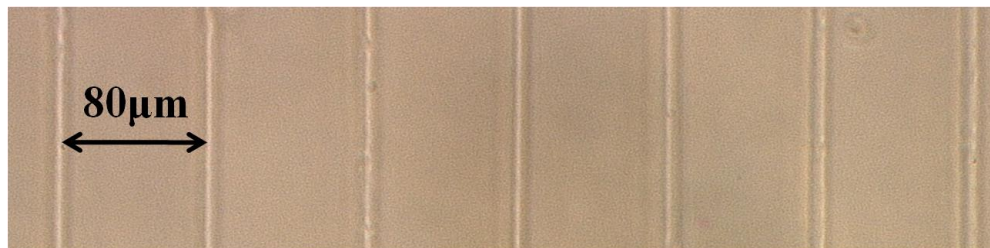
図3-2-1-f-8. レンズを用いた逐次加工による回折格子の顕微鏡像
