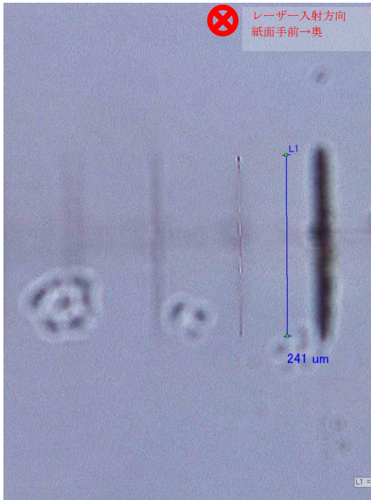
図 KF15 40x (0.55) レンズを併用したホログラム (4 段型) 加工による異質相の光学顕微鏡画像。パルス幅 : 570fs (AC)、平均出力 : 300mW、照射時間 : 10sec
