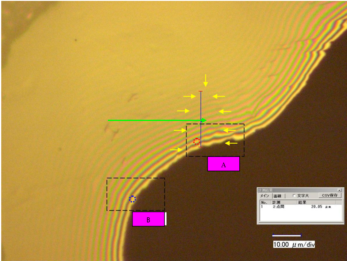
図 GF23 TEM 観察位置の光学顕微鏡像。異質相部：赤丸、母材部：青丸
