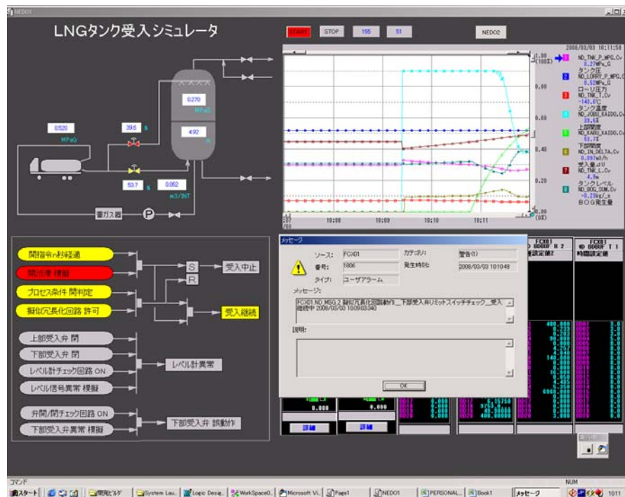
図 3.2.3.8-8 弁リミットスイッチの擬似冗長化アルゴリズムの動作確認
