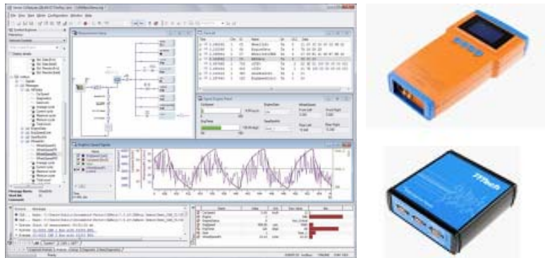
図Ⅲ2.1.2-52 通信障害挿入試験装置
