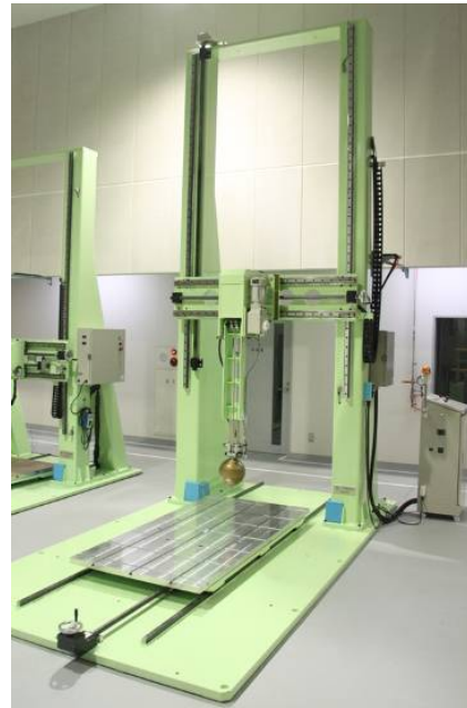
図III.2.1.2-16 耐衝撃試験機の外観
