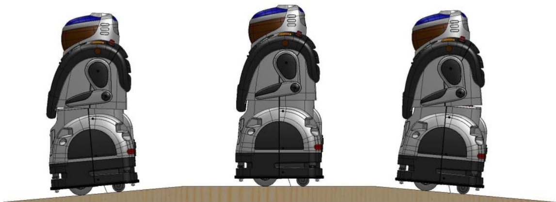
図 III.2.4-13 坂道走行での姿勢制御のイメージ
