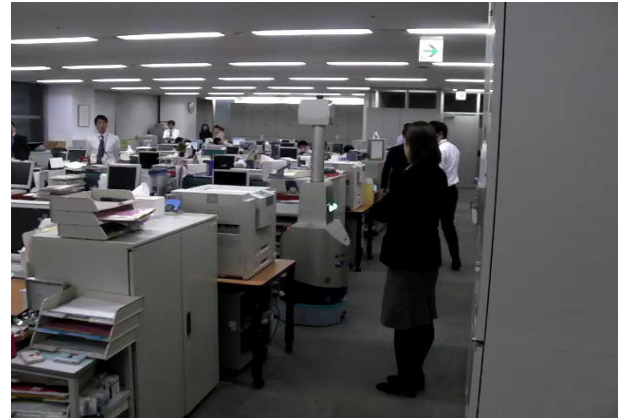
図IV.3-3 専用部小型清掃ロボット
