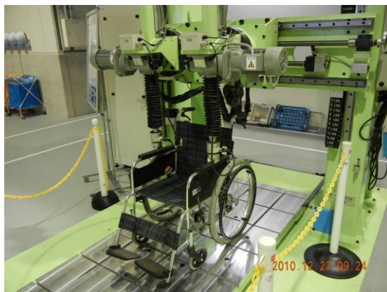
(a) 耐荷重試験
