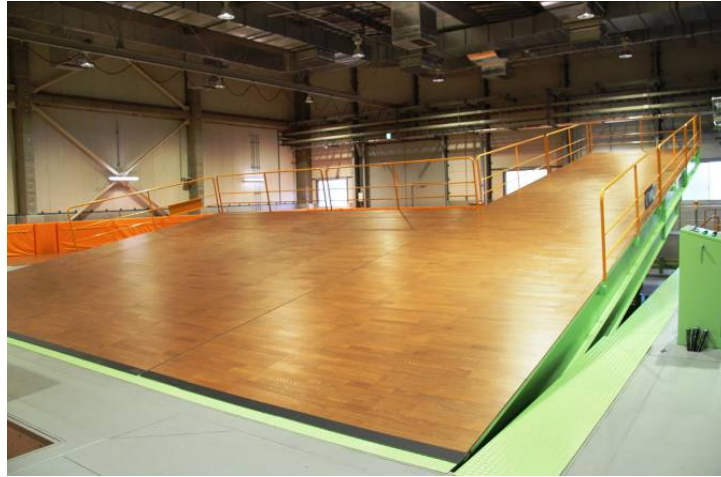
図Ⅲ2.1.2-21 傾斜路走行性試験装置
