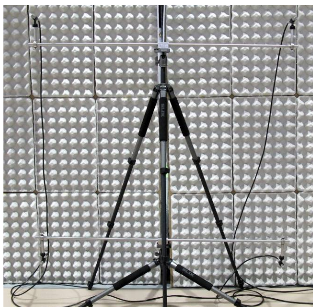
図Ⅲ.2.1.2-14 通過騒音測定用 4 マイクロホンの設置状況 (1m 四方の頂点に配置、後方は吸音材)
