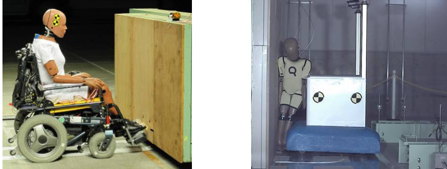
図Ⅲ.2.1.2-38 対人安全性能に関する基礎試験状況
