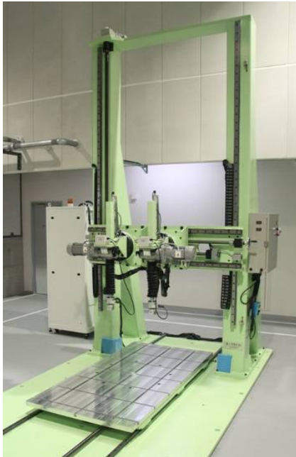
図III.2.1.2-15 耐荷重試験機の外観
