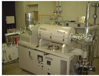
過熱水蒸気によるスクラップ洗浄装置
