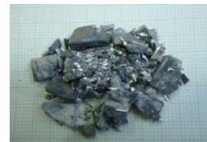
過熱水蒸気処理済みAZ91 塗装材
