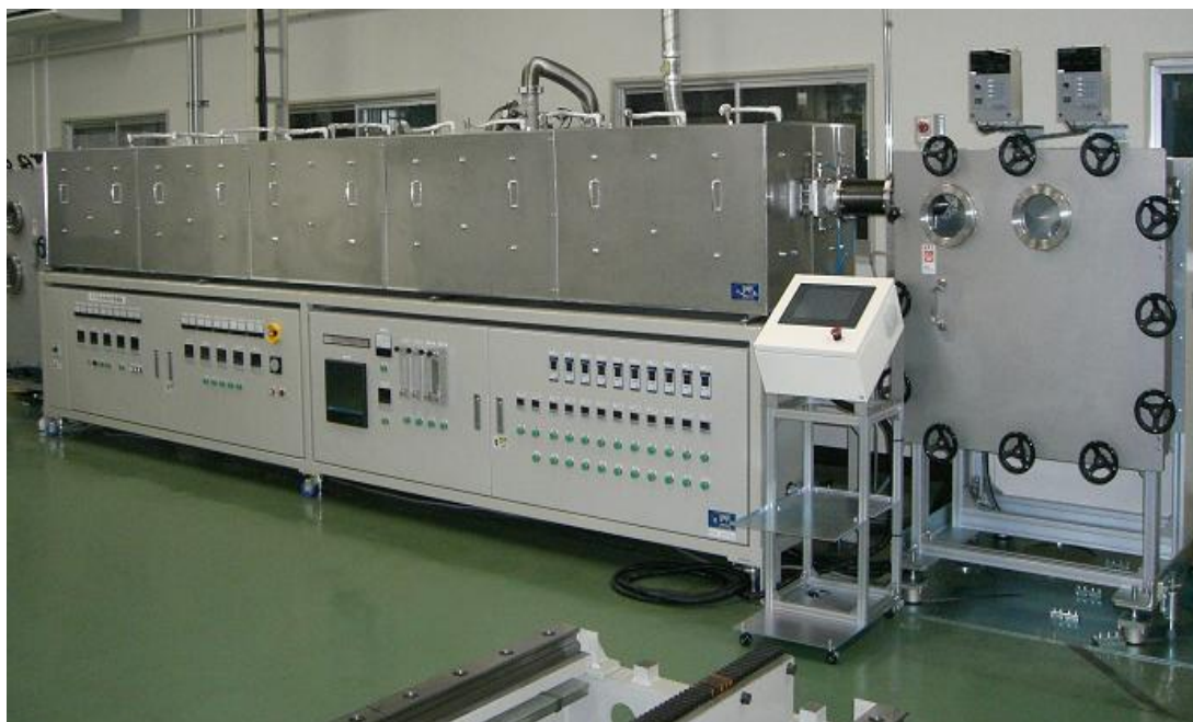
図 2.1.2-20 RTR式本焼炉外観
