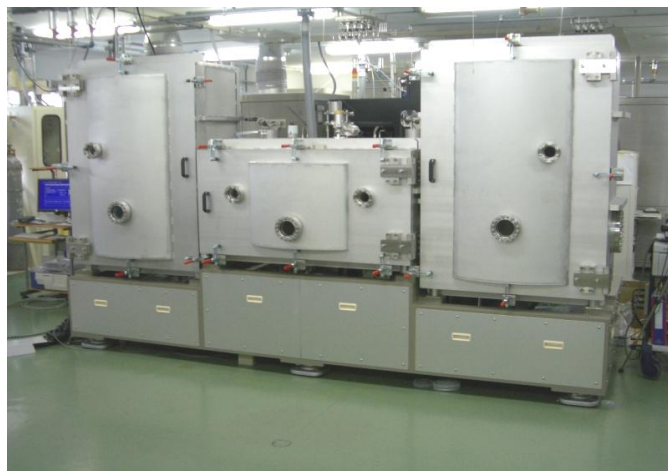
図 2.1.1-3 エキシマレーザー PLD 装置(マルチターン方式)
