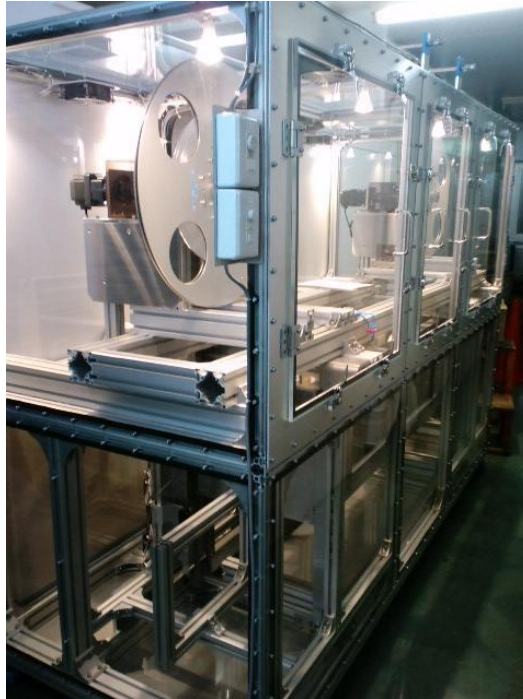
図 2.1.2-28 リール式複合材料搬送機構の写真
