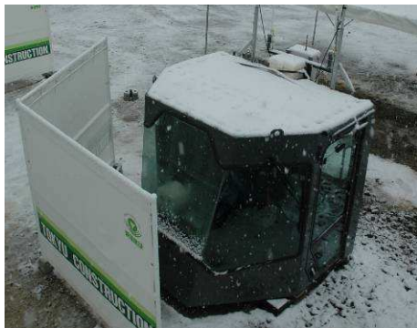
図 41 遠隔操作室の耐候性評価状況
