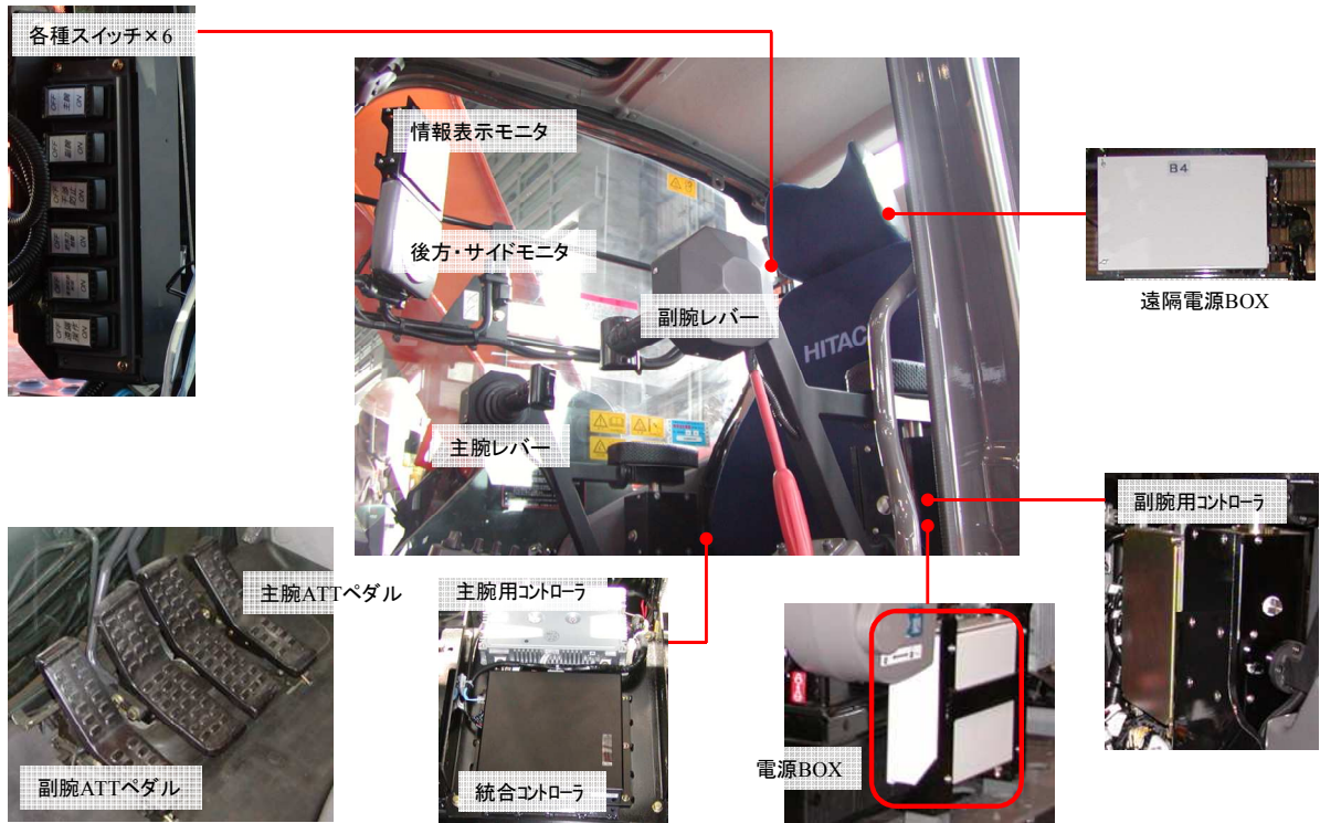
図 25 運転室内搭載機器
