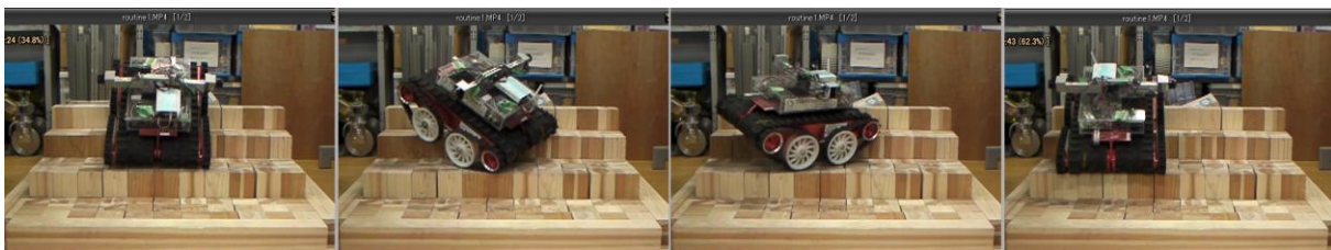
図 5 0 サブローラを折り畳んだ場合の半自律走行（ステップフィールドでの旋回動作）
