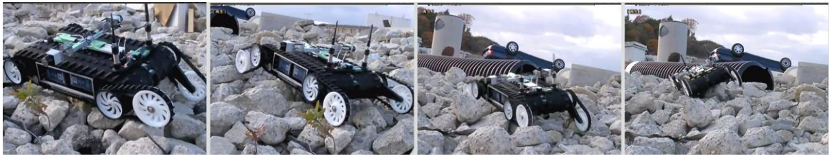
図 4 8 Quince の半自律走行（兵庫県三木市消防学校における不整地走行）
