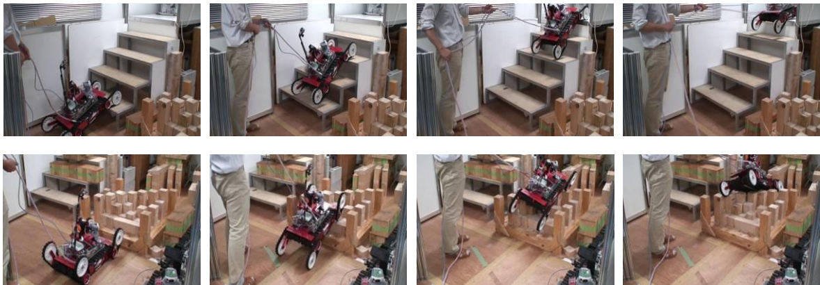
図 4 4 衝突判定に基づく半自律での階段、ランダムステップ踏破
