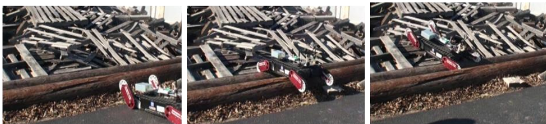
(b) 木材瓦礫を半自律操縦支援システムを用いて踏破
