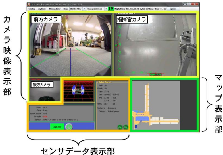
図 3 7 操縦卓の表示例（ドア開放時）
