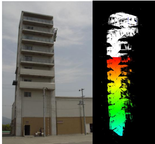
図 70 3次元オドメトリによる地図構築
