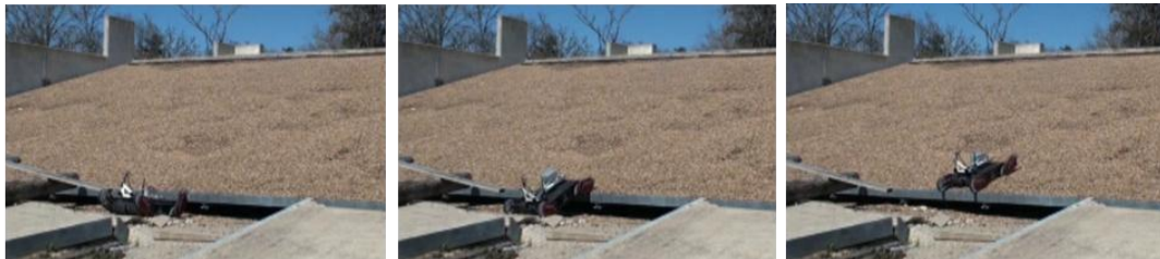
(a) 倒壊建物の屋根を半自律操縦支援システムを用いて踏破
