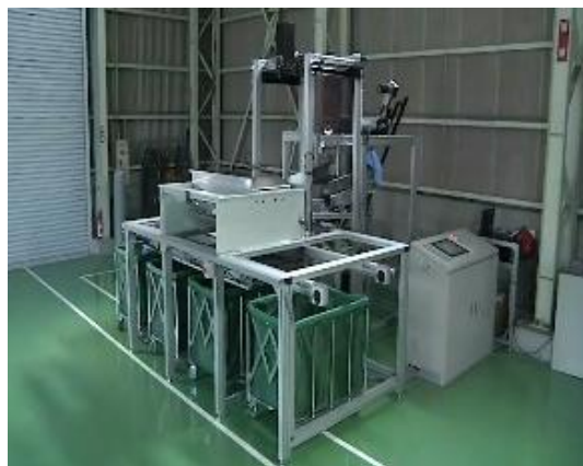
図 2.1-46 混流洗濯物投入分類システム
