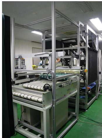
図 2.1-39 3段コンベアによる表裏反転・排除
