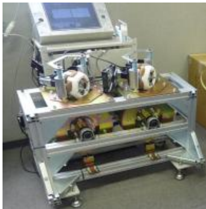
図 4 車輪単体評価装置
