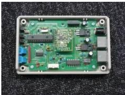
図 42 大規模センサネットワーク構築可能なタグコントローラとハンドオーバ機能を利用した広範囲タグ追跡
