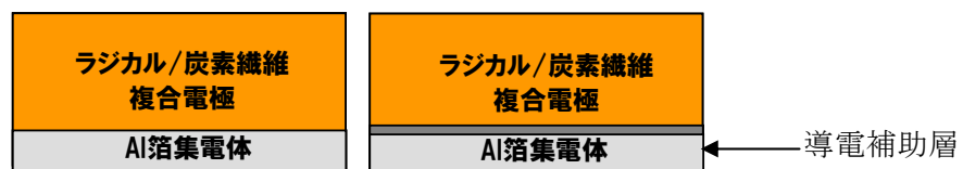
図 2.3.3-24 従来電極 (単層複合電極) (左)、二層複合電極 (右)
