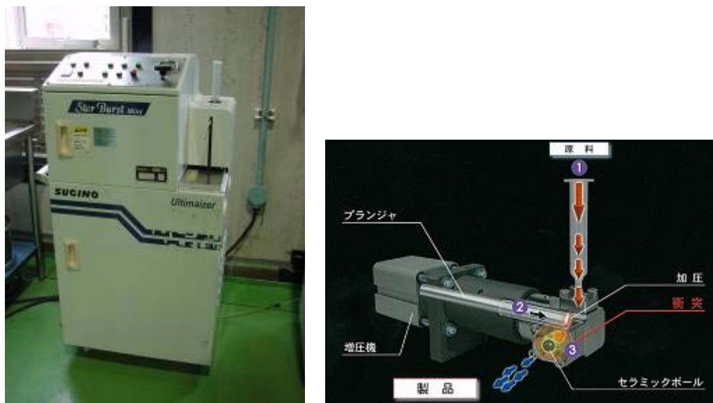
図 2. 3. 2. 2-1 高圧噴射流式湿式微粒化装置
