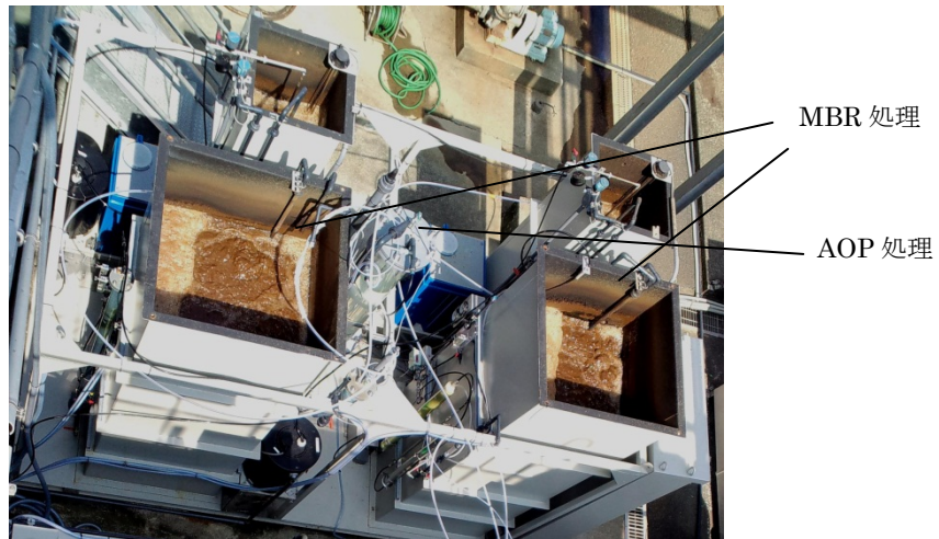
図Ⅲ. 2. 7-17 ジオキサン連続処理フロー
