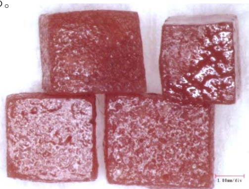
図Ⅲ. 2. 8-12 アナモックス菌の包括固定化担体
