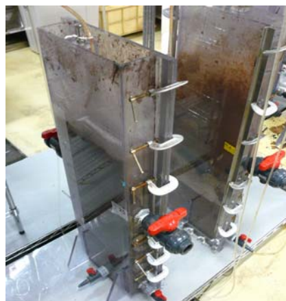
小型試験装置 (水槽容積6L、A4膜エレメント1 使用)
