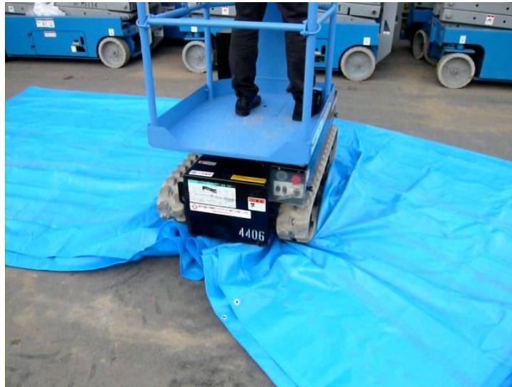
図 2.3-3 シート上走行実験 (キャタピラ式)
