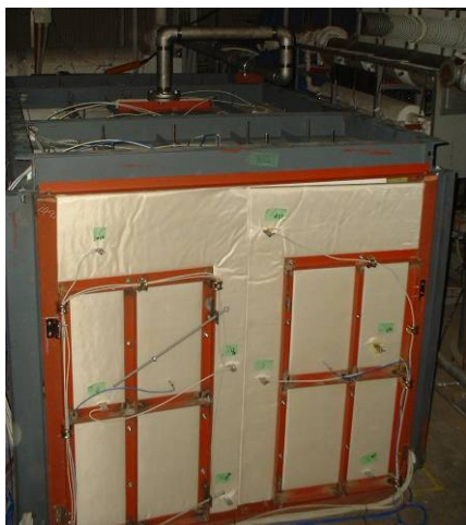
写真-1.3-上) パイロット規模処理炉
