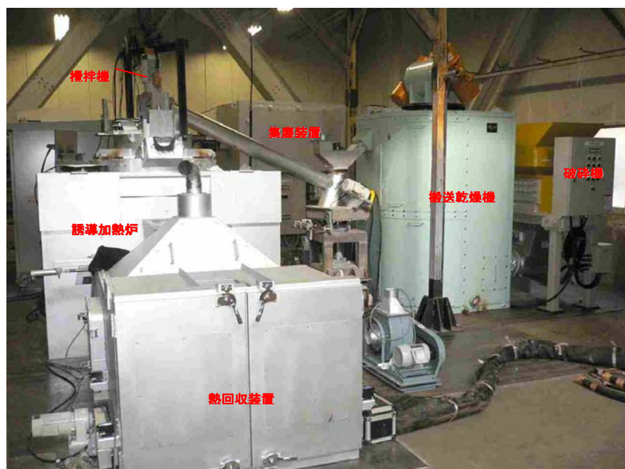
図 27 一体化システムの配置状況
