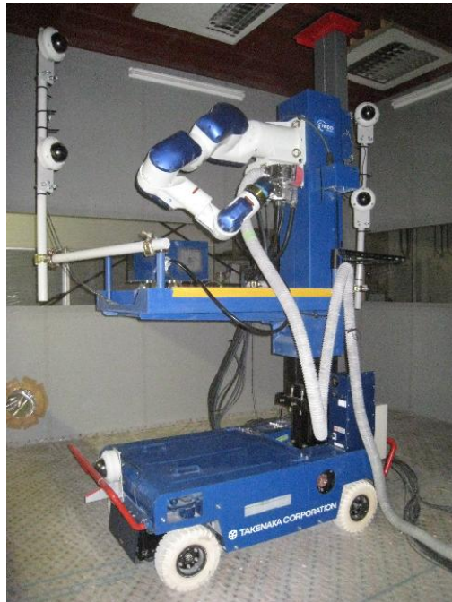
図 5.1-2 剥離ロボット全景
