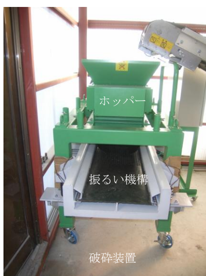
写真4-3 破砕装置 外観
