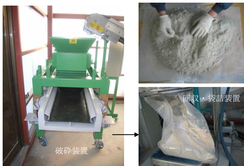
写真 6-14 破碎後の模擬吹付けアスベストの回収状況
