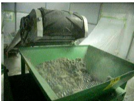
写真 7-7 アスベスト廃棄物を破砕装置に送り込み
