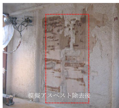
写真 6-6 模擬吹付けアスベスト除去実験状況 写真 6-7 除去後の壁面
