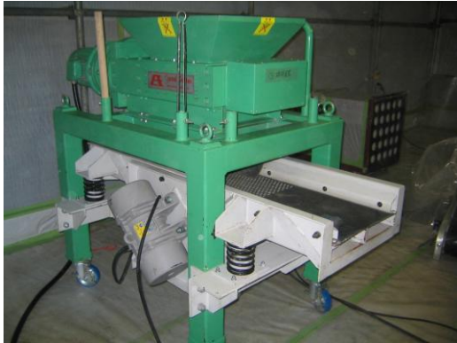
写真 7-14 破碎装置（清掃後）
