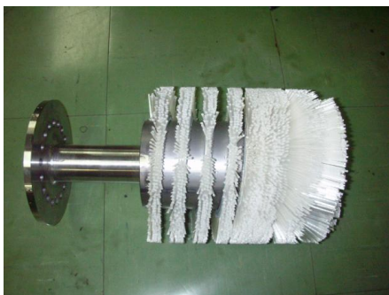
写真 3-6 仕上げ用剥離機
