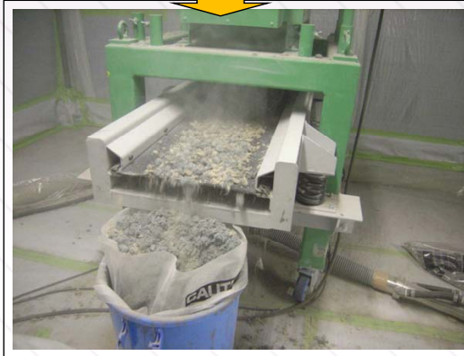
破碎装置(ラス網裁断可能)
