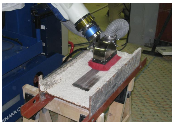
図 3.3-1 剥離装置の動作確認状況
