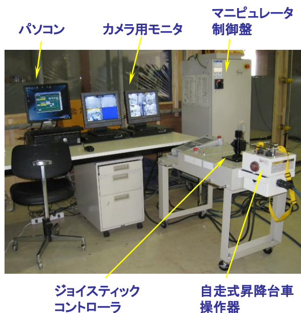
図 2.1-3 剥離ロボット操作システム
