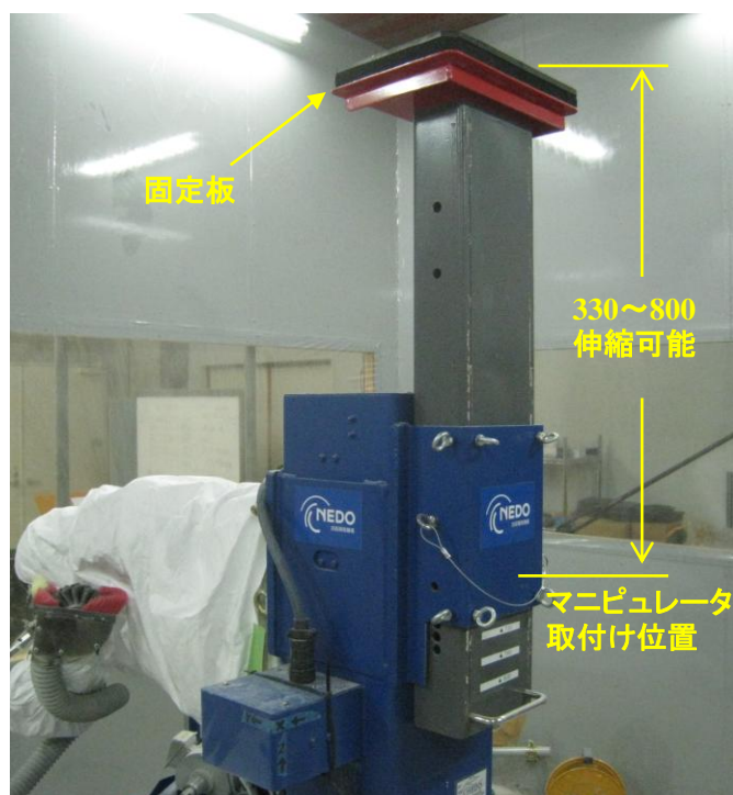
図 2.3-5 マスト頂部押し当て式固定機構
