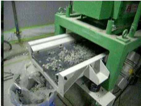
写真 7-8 アスベスト廃棄物の裁断及び振り分け
