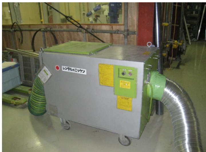
図 5.1-5 実大実証実験室負圧集塵機
