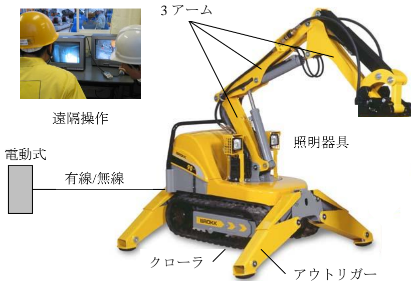
図 2-1 湿式系吹付けアスベスト除去ロボットベースマシン
