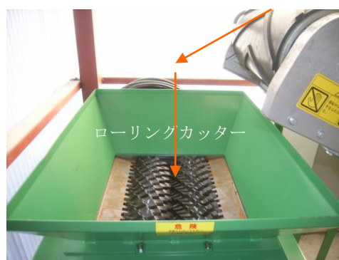
写真4-4 破砕 (カッター) 部
