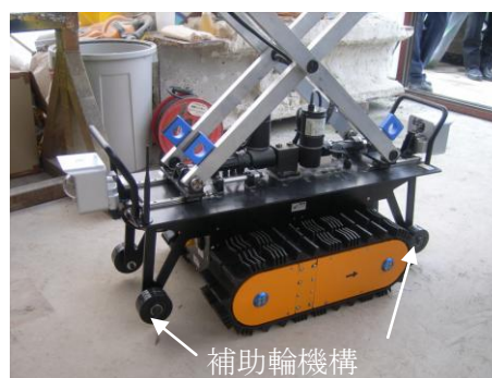
写真 5-1 無線式監視カメラ装置 外観
