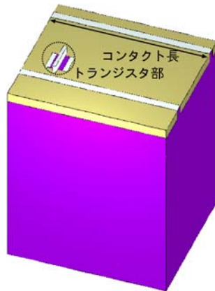
Ⅲ-2-I-③-(2)-図 1)-4-1: TCAD 解析における標準トランジスタ構造。幅 4\mu\text{m} , 奥行き 3\mu\text{m} , Si 領域深さ 5\mu\text{m} 。
