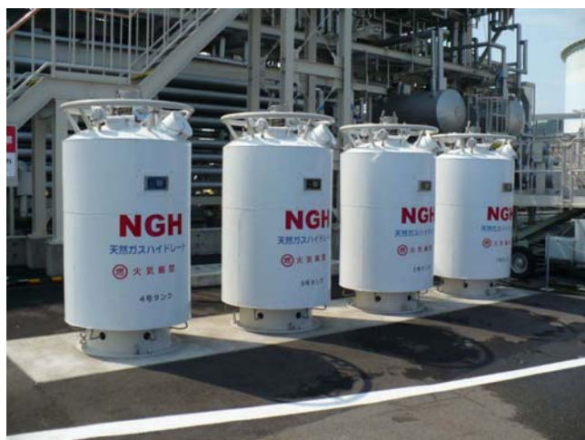
縦型容器 1~4号 (最大積載量: 200kg/基)
