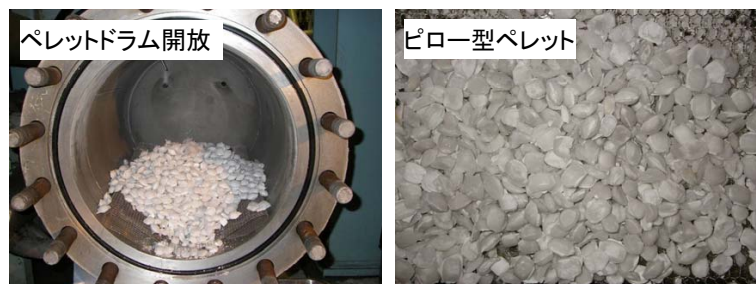
図 三井造船(株)千葉技術開発センターにあるBench Scale Unit (BSU)による連続運転時のペレット取出し状況
