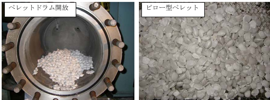
写真 2.1.2.2-1 BSU 連続運転時のペレット取出し状況
