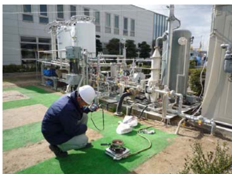
屋外でのコンロ燃焼試験
