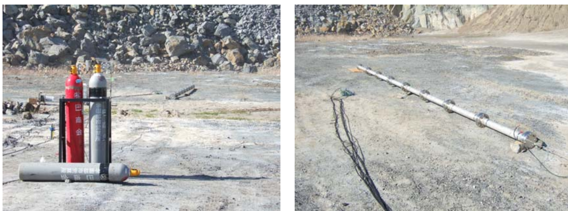
図 2.3(5)④b-2 100mm 径デトネーションチューブの野外実験の配置図
