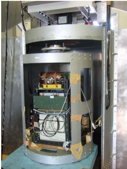
図 2.3(5)⑤-4 微小重力実験落下カプセル (二重構造) とその中に組込まれた燃焼実験装置
