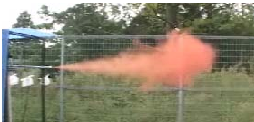
図 2.3(5)②a-1 水素による酸化鉄の噴出実験の様子
