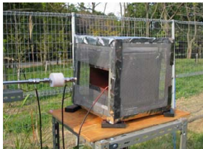
図 2.3(5)②a-2 静電気計測装置の概要と写真
