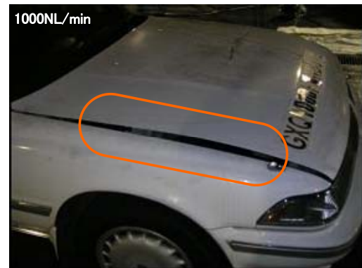
引火後の車両の損傷程度
