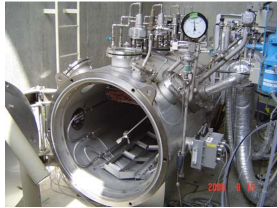
ガス透過試験装置フロー図（左）および ガス透過試験装置外観写真（右）
