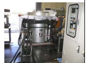
150kw誘導加熱装置
