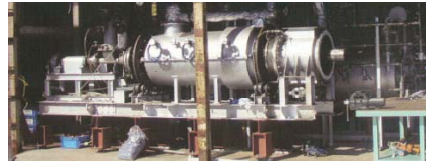
熱分解無害化炉
