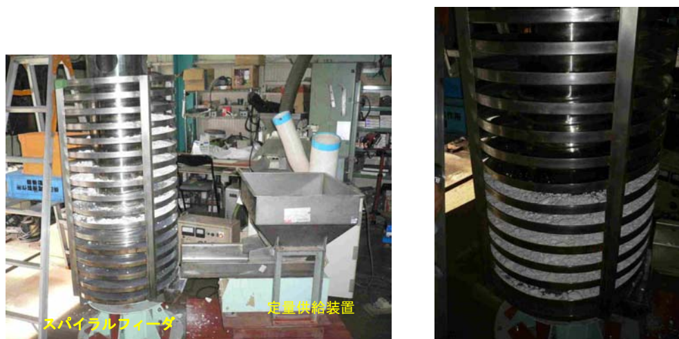
装置サイズ (外径 650φ-内径 350φ、16 段 (搬送距離: 約 25m))
