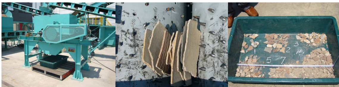
写真-2.2 破砕装置による実験状況
