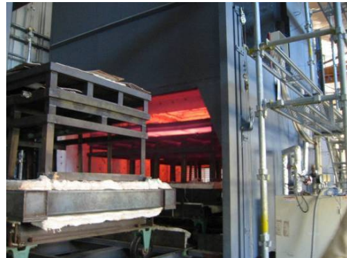
写真-1.7 連続試験状況
