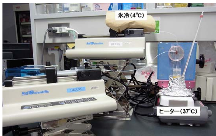
図①-(2A)-2-2.4 初期セットアップ。温度管理を行うことで安定してコラーゲンゲルビーズを作製できるようになった。
