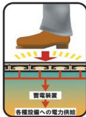
図表 床発電システムの仕組み
