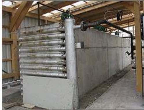
図表 5.27 コンクリート蓄熱システム（ドイツ航空宇宙センター実験設備）
