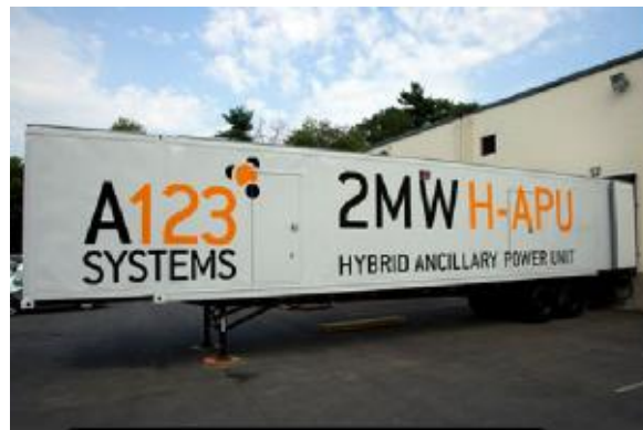
図表 9.22 A123 の移動型系統安定化用蓄電池 (2MW-15 分)
