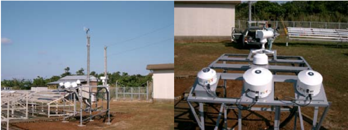
図 2.2.3-2 観測点の外観写真（沖永良部地点 左：全景写真、右：各種日射計）
