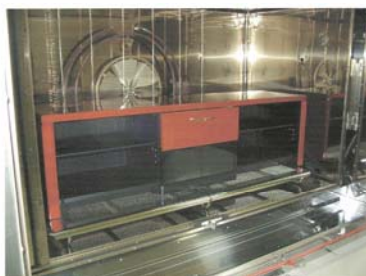
写真2. 試料を大形チャンバーに設置した写真 (横から)
