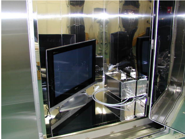
図Ⅲ-2-2-3大形チャンバーによるプラズマテレビの測定
