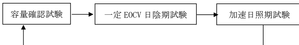
図 3.2.12.1-4 一定 EOCV 静止軌道衛星模擬試験フロー
