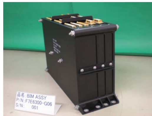
バッテリーインタフェースモジュールアセンブリ 検証モデル
