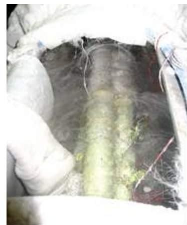
図 2.1.5-5 三心コアサンプルの LN2 中での引張試験状況
