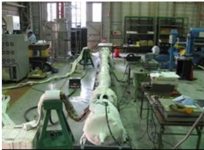
図 2.1.3-15 中間接続部冷却機械試験状況
