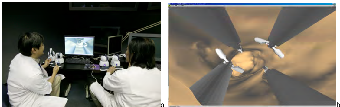
図 48 触覚呈示装置 4 機を用いた胃内でのシミュレーションの様子
