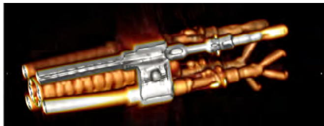
図23 X線CT装置による内視鏡先端部の状況ならびに駆動ワイヤを含む内部構造の計測
