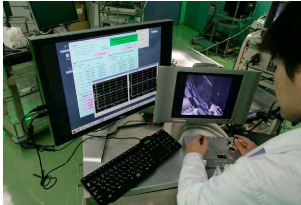
図32 試作した消化器外科用手術コクピットにおいてロボットアームのワイヤの状態, およびロボットアームで把持した対象物の柔らかさをモニタしながらロボットアームの操作を行っている様子
